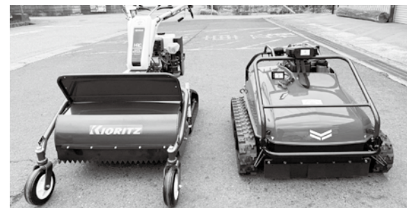
▲ハンマーナイフモア(写真左)、ラジコン草刈機(写真右)
