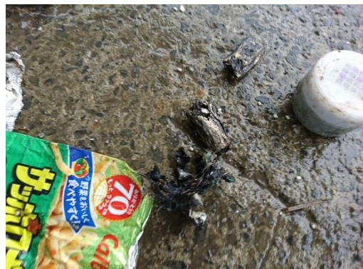
発火したリチウムイオン電池
