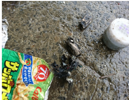
発火したリチウムイオン電池
