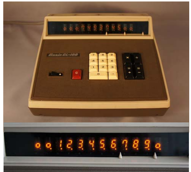
（写真5）ニキシー管 電子式卓上計算機と表示画面 城陽市歴史民俗資料館蔵
